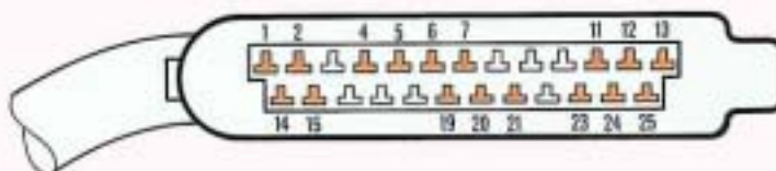
KONTAKTIERUNG DES ZENTRALSTECCKERS
